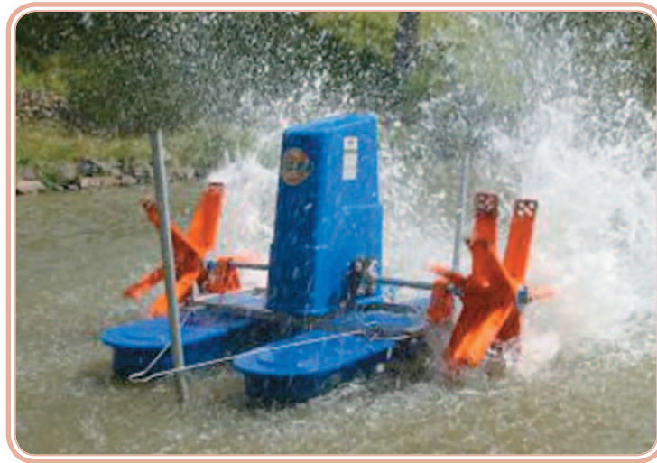
Figura 6.2: Aerador em um viveiro em ação
