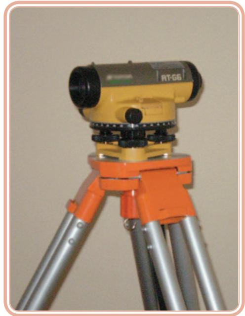
Figura 2.10: Nível sobre tripé. A luneta do nível é fixa sob o eixo horizontal, ou seja, ela aponta sempre para o horizonte
