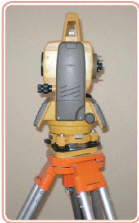
**Figura 2.3: Estação total vista de lado sobre tripé, luneta apontada para o horizonte.**
