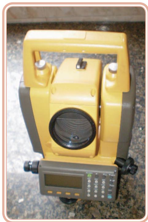
Figura 2.1: Estação total vista de frente, teclados de comandos e *display* de visualização
