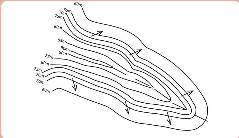
**Figura 4.12: Formato de um espigão em curvas de nível**
