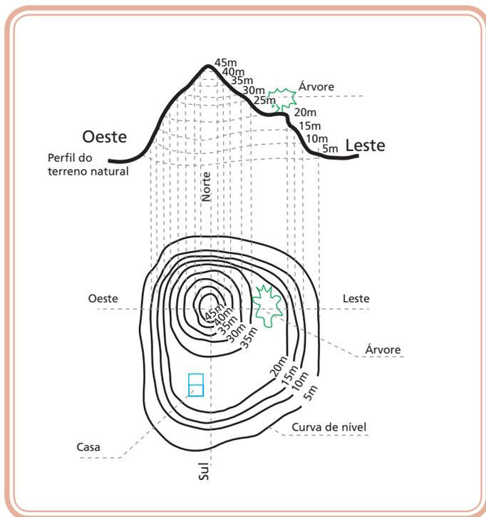
**Figura 4.9: Vista em perfil e curvas de nível de uma elevação com 40m de altura (vista no sentido sul-norte)**
