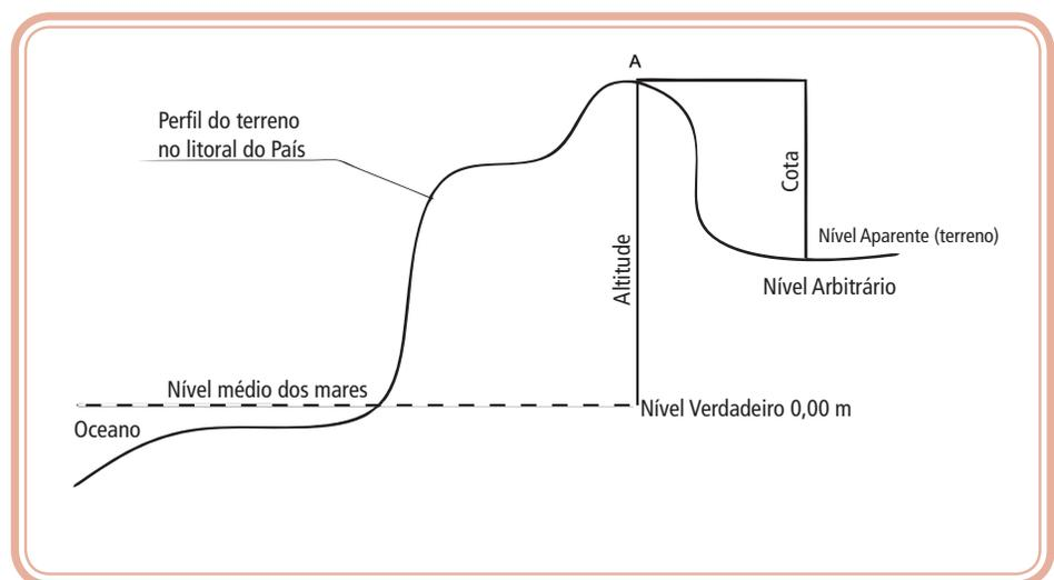
**Figura 4.1: Esquema gráfico mostrando a altitude e a cota de um ponto no terreno**
