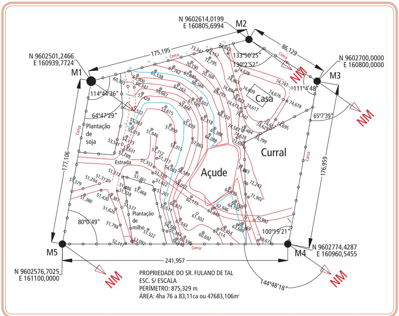
Figura 3.17: Levantamento planialtimétrico de uma propriedade rural
