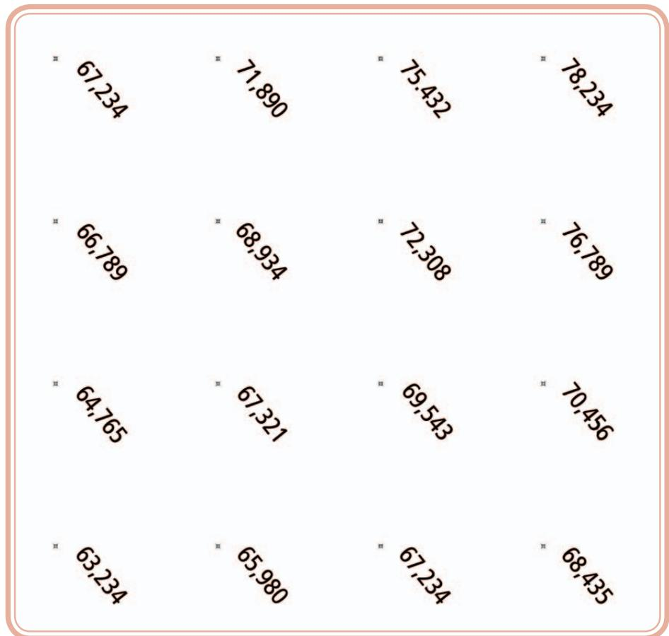
Figura 4.21: Plano cotado para traçado de curvas de nível
