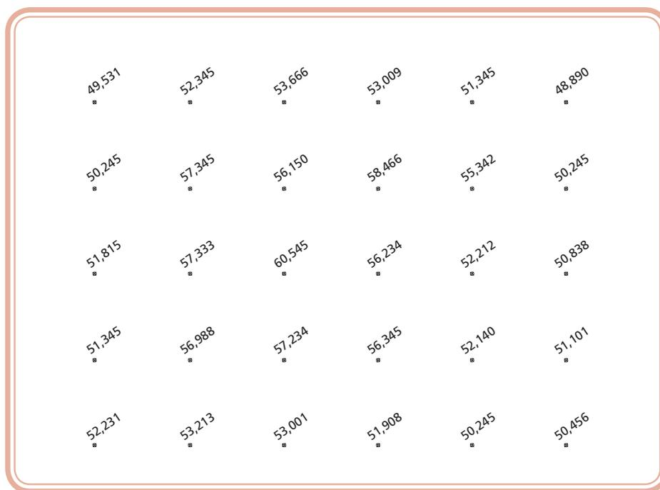
Figura 4.7: Plano cotado para traçados de curvas de nível
