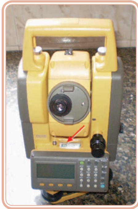
**Figura 2.2: Estação total vista de costa. Repare na seta indicando a posição do nível de bolha**
