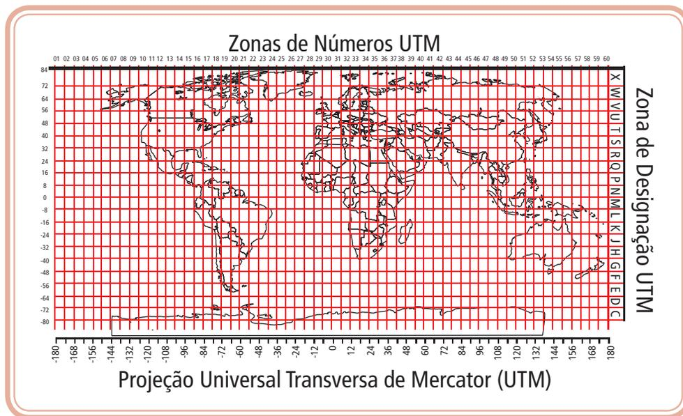
**Figura 3.8: Projeção Universal Transversa de Mercator (UTM)**
