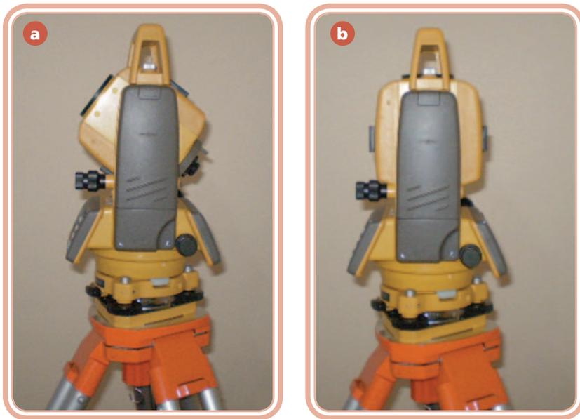
**Figura 2.4:** a) Estação total vista de lado sobre tripé, luneta apontada a 45° do horizonte; e b) luneta apontada para o zênite
