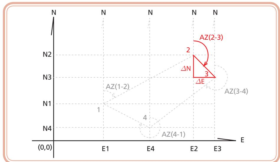
Figura 3.12: Distância e azimute do alinhamento 2-3 destacados da poligonal
