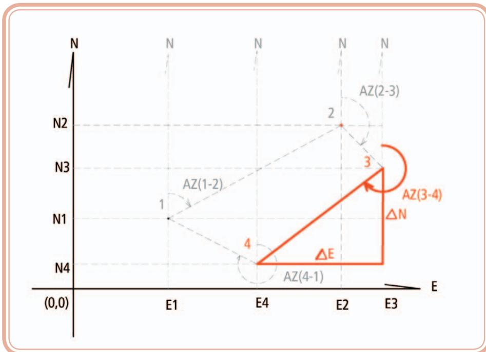
**Figura 3.13: Distância e azimute do alinhamento 3-4 destacados da poligonal**
