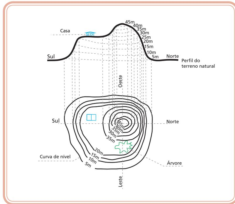
**Figura 4.10: Vista em perfil e curvas de nível de um morro com 40m de altura (vista no sentido leste-oeste)**
