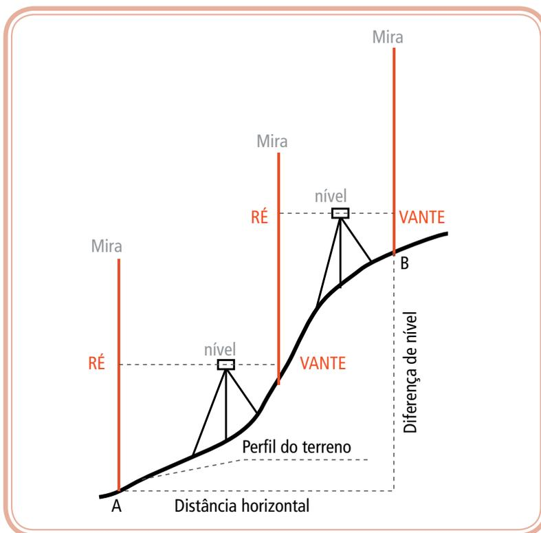
**Figura 4.2: Esquema gráfico do transporte de altitude no terreno do ponto A para o ponto B**
