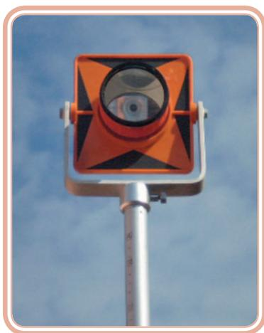
**Figura 2.5:** Prisma sobre bastão de 2,70 m de altura
