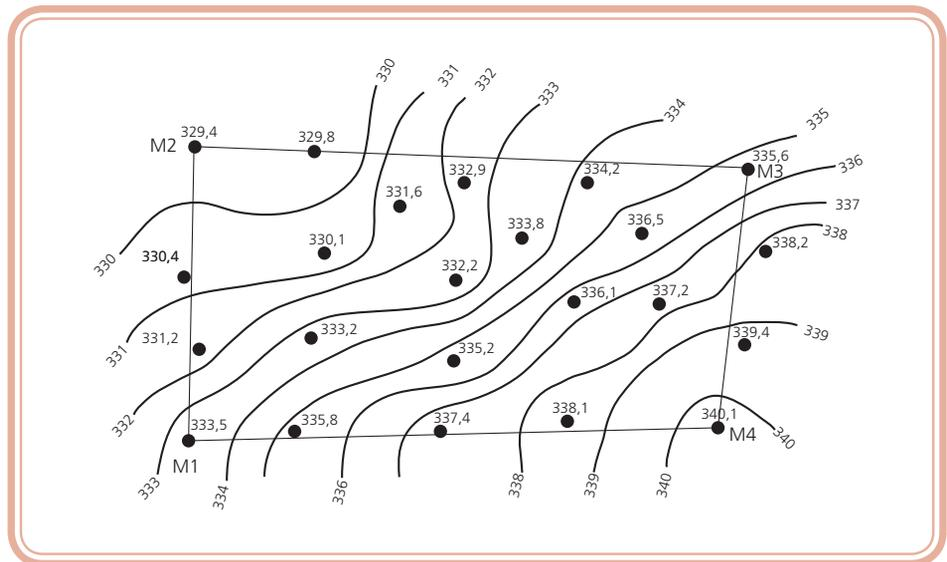
**Figura 4.6: Curvas de nível traçadas a partir de um plano cotado**
