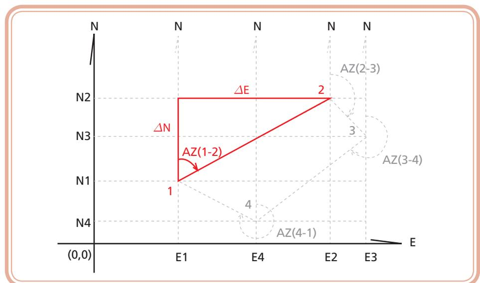
Figura 3.11: Distância e azimute do alinhamento 1-2 destacados da poligonal
