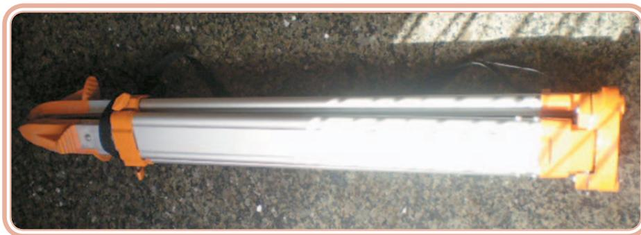
Figura 2.12: Tripé em alumínio para suporte de estação total e nível
