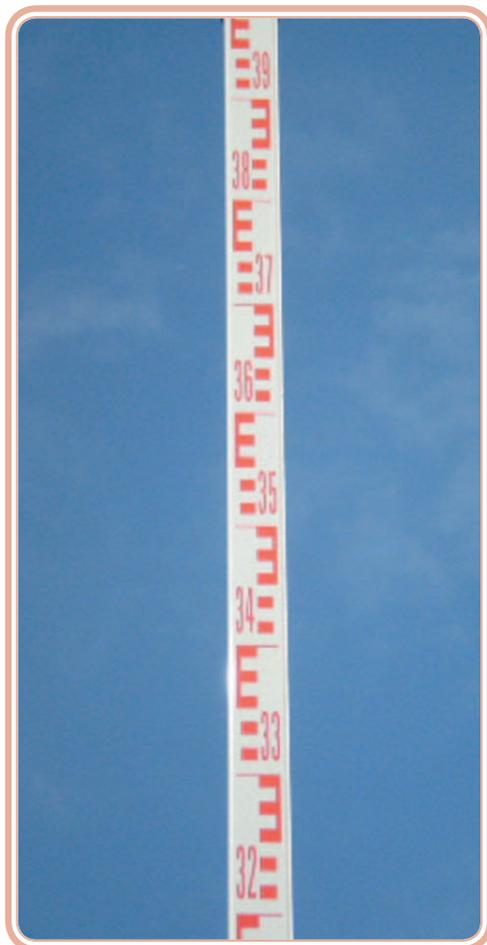
Figura 2.11: Mira de quatro metros, graduada em metros, decímetros, e centímetros
