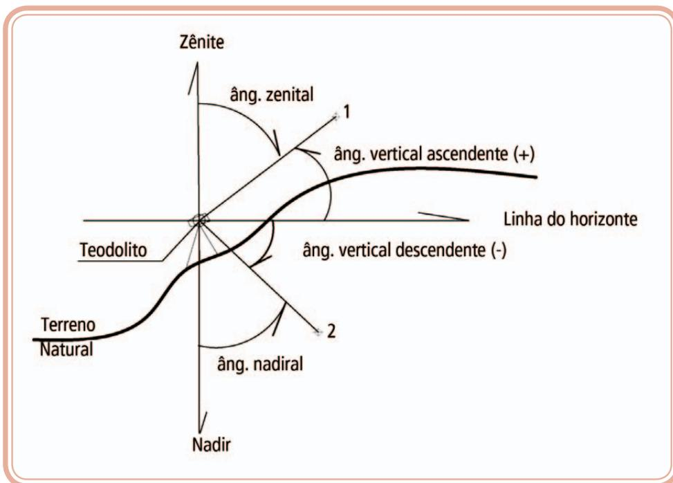
Figura 3.7: Indicações de ângulos verticais, zenital e nadiral em relação à linha do horizonte
