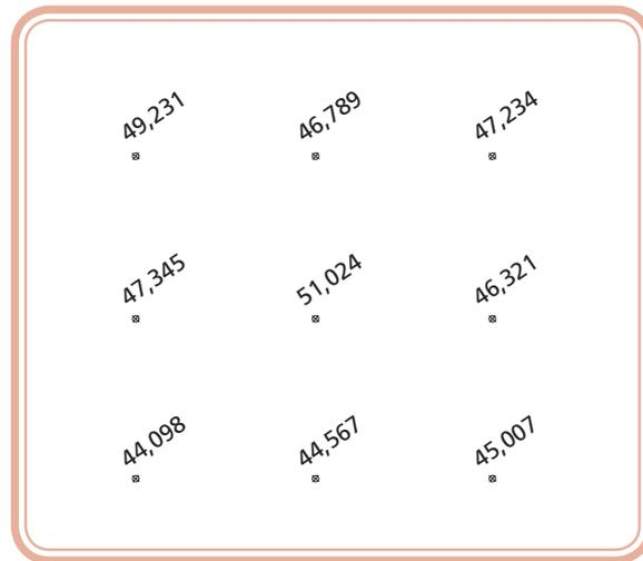
Figura 4.8: Plano cotado para traçados de curvas de nível
