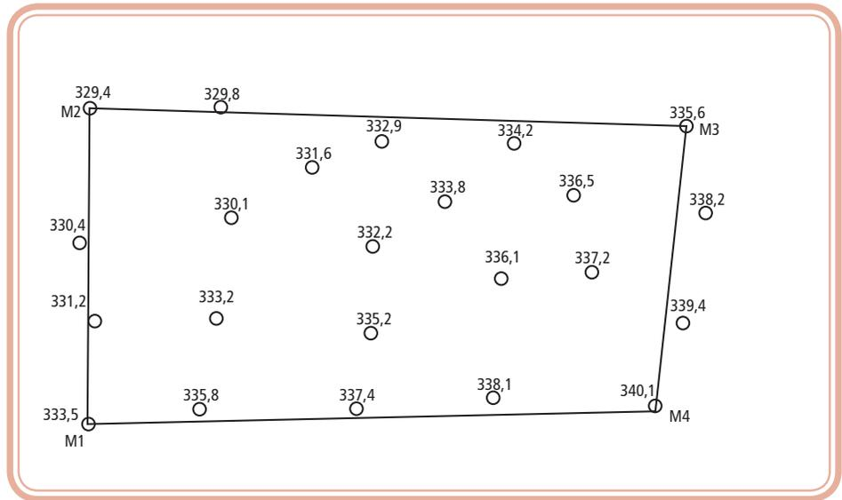
**Figura 4.5: Plano cotado no polígono com vértices M1, M2, M3 e M4**
