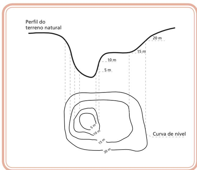
**Figura 4.11: Vista em perfil e curvas de nível de uma depressão com aproximadamente 15 metros de profundidade**
