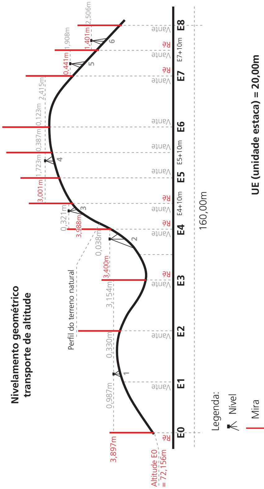
Figura 4.3: Transporte de altitude do ponto E0 ao ponto E8
