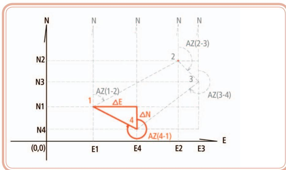
Figura 3.14: Distância e azimute do alinhamento 4-1 destacados da poligonal
