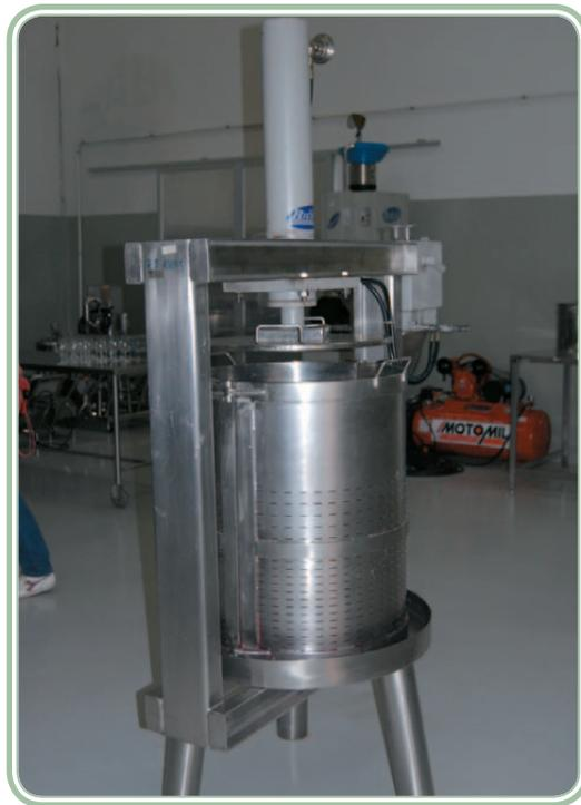
**Figura 2.6: Prensa vertical pneumática em aço inox**
