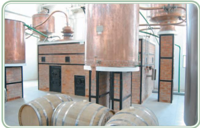
**Figura 2.4: Alambique de batelada em cobre**
