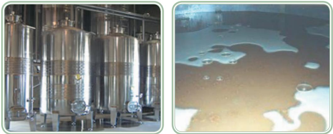
**Figura 5.8: Fermentação na vinificação em branco, interior e exterior das dornas**
