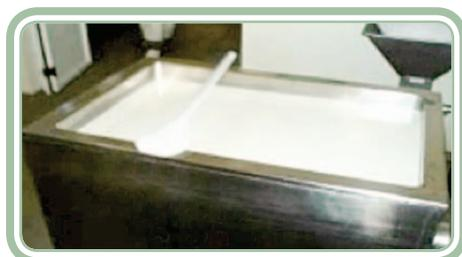
**Figura 7.4: Tanque de coagulação do leite**
