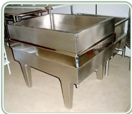
**Figura 6.4: Tanque de fermentação para produção de queijos em aço inox**
