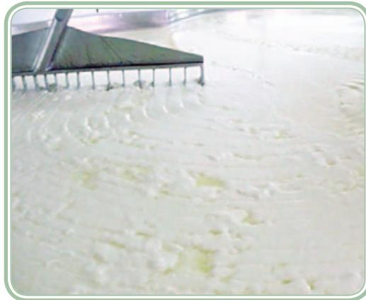
**Figura 6.6: Corte da coalhada utilizando a lira**
