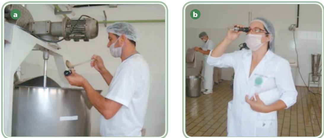
**Figura 10.9: (a) Colocação do doce de leite no refratômetro (b) Leitura do grau Brix no refratômetro**
