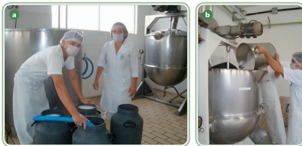
**Figura 10.2:** Transferência do leite do tanque para o latão e, em seguida, para o tacho
