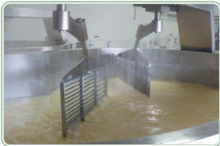
**Figura 8.2: Soro sendo aquecido em constante agitação**
