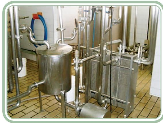
**Figura 4.12: Pasteurizador de placas**
