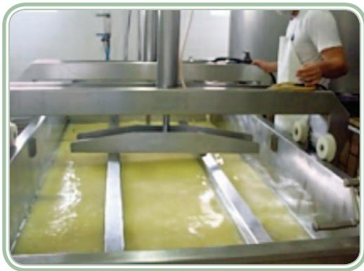
**Figura 6.11: Pré-prensagem da massa (mecanicamente)**
