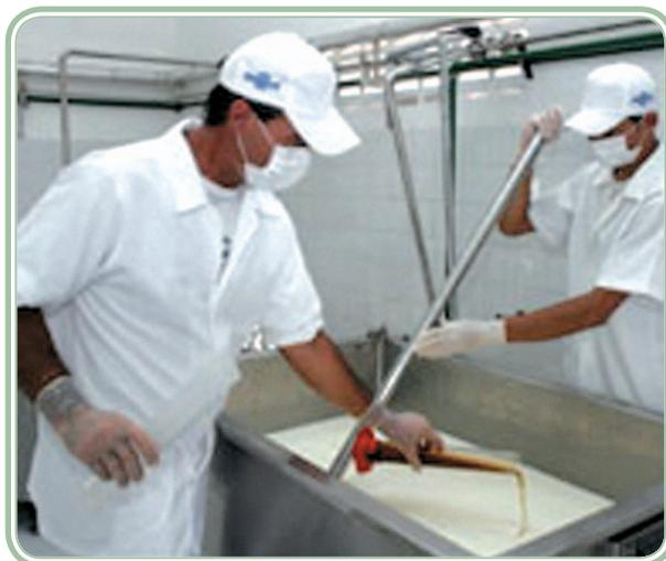
**Figura 8.4: Adição do ácido ao soro com o leite**
