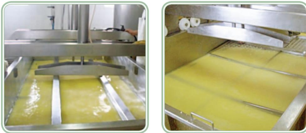
**Figura 9.5 e 9.6: Processo de dessoragem e pré-prensagem**
