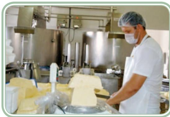
**Figura 9.8: Massa cortada em blocos de 10 kg**
