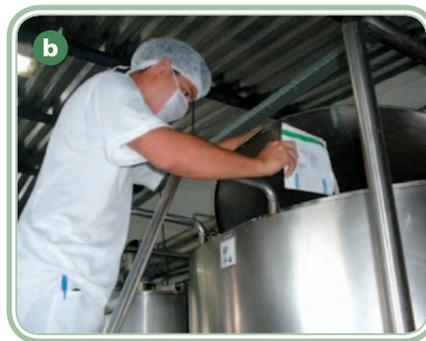
**Figura 11.7: (A) Tanques de fermentação (B) Inoculação do fermento lácteo**
