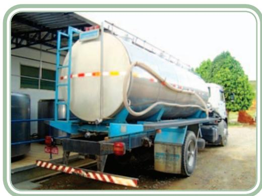
**Figura 4.1: Caminhão isotérmico de coleta e transporte do leite**
