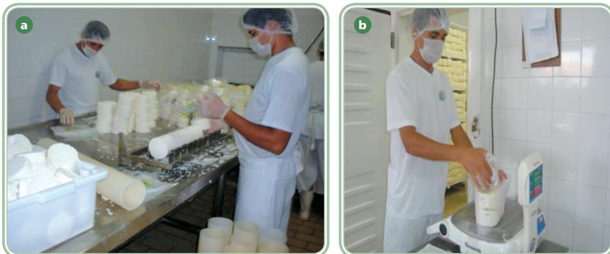
**Figura 8.9: (a) Desenformagem e embalagem; (b) pesagem da ricota embalada**
