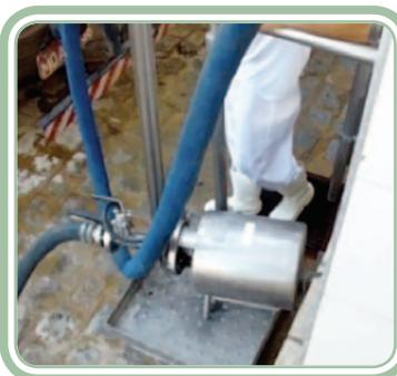
**Figura 4.3: Bomba sanitária para transferência do leite**
