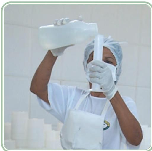
**Figura 8.3 Medindo ácido láctico, cítrico ou acético para adicionar ao soro**
