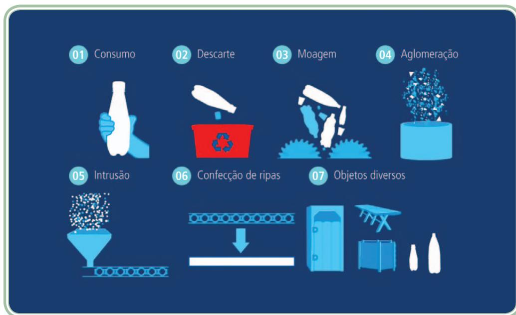
**Figura 6.17: Esquema do processo de reciclagem do plástico**
