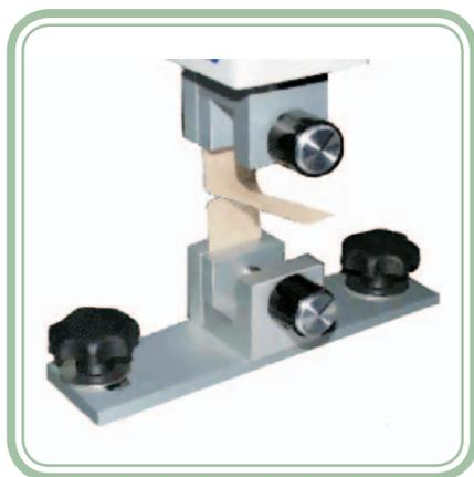
**Figura 3.4: Esquema ilustrativo da medição da força de delaminação de uma embalagem composta pela união de pelo menos 2 camadas diferentes**
