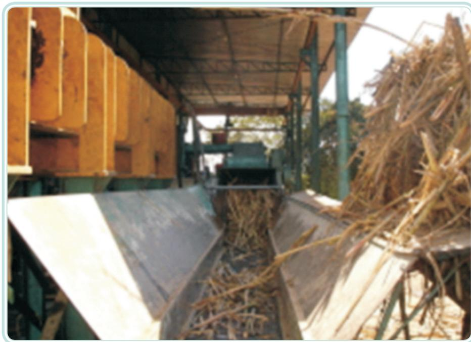
**Figura 2.15: Recepção e moagem da cana-de-açúcar**
