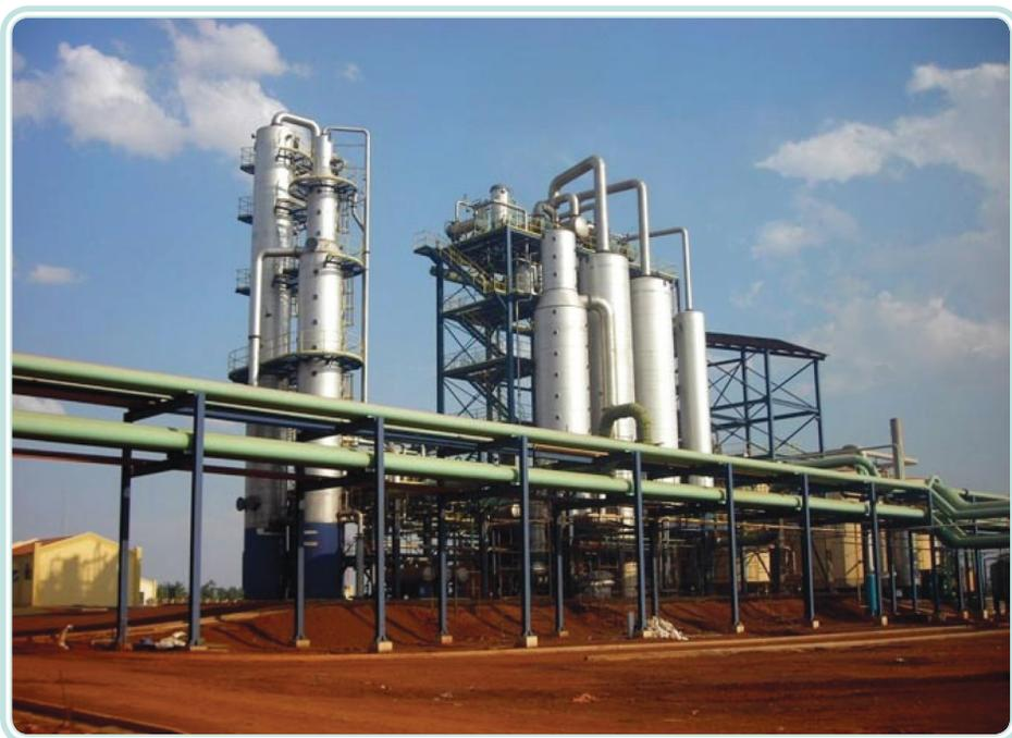
**Figura 4.1: Usina de destilação do álcool**
