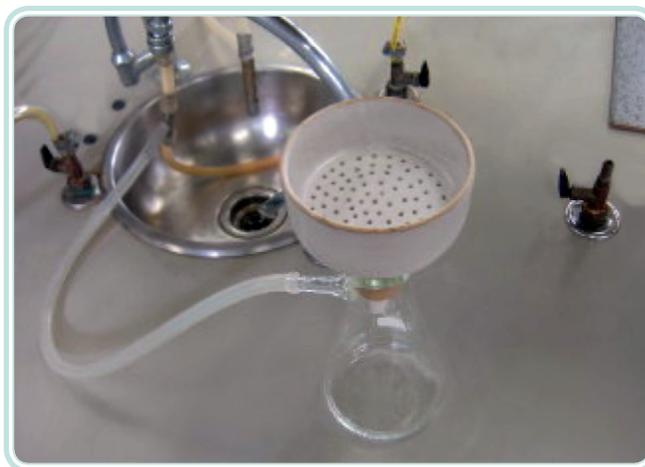
**Figura 2.24: Trompa d'água**
