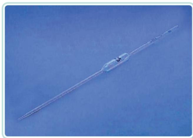
**Figura 3.9: Pipeta volumétrica**
