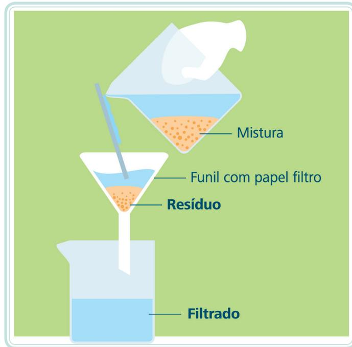
**Figura 3.14: Processo de filtração**
