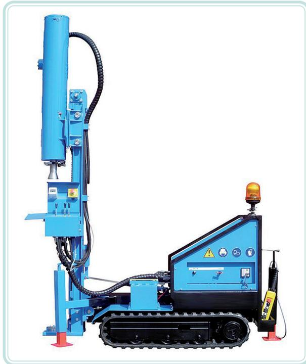
**Figura 6.4: Penetrômetro**
