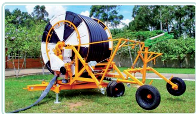
**Figura 7.12: Irrigação por aspersão, autopropelido, em cana-de-açúcar**
