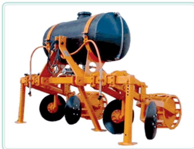
**Figura 7.5:** Cobridor de cana-de-açúcar com aplicador de inseticida ou cupinicida
