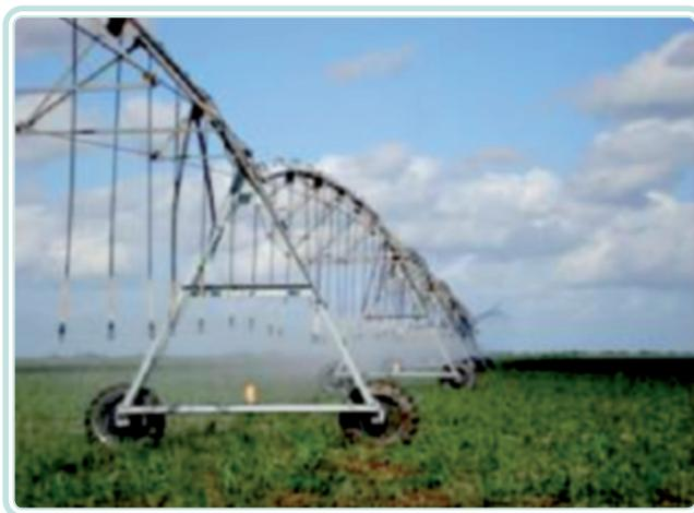
**Figura 7.10: Irrigação por aspersão, tipo pivô central rebocável, em cana-de-açúcar**
