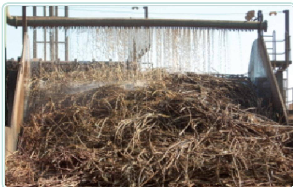
**Figura 5.4: Lavagem da cana-de-açúcar para retirada de impurezas**
