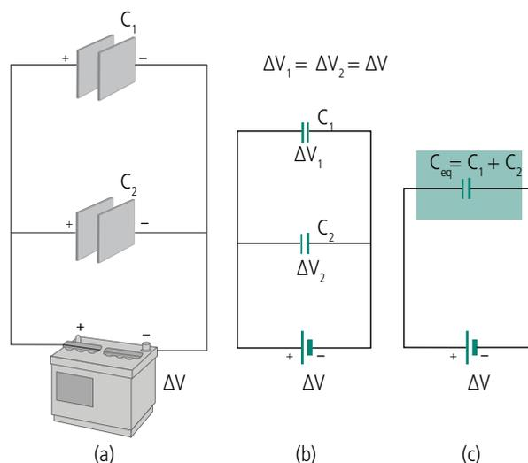
**Figura 5.5: Associação em paralelo de capacitores: (a) Dois capacitores em paralelo conectados a uma bateria; (b) Representação gráfica do circuito dos capacitores em paralelo; (c) Circuito equivalente dos capacitores em paralelo**
