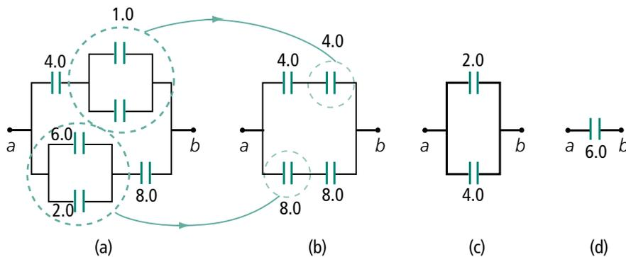
**Figura 5.8: Associação mista de capacitores: (a) Capacitores em série com associações de capacitores em paralelo; (b) Capacitância equivalente dos capacitores em paralelo; (c) Capacitância equivalente dos capacitores em série; (d) Capacitância equivalente total do circuito**
