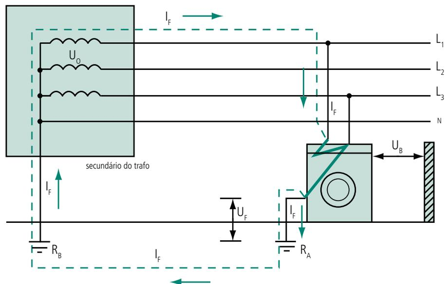
**Figura 10.1: Esquema TT – aterramento com eletrodos independentes**
