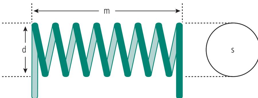
**Figura 4.11: Dimensões consideradas no cálculo da indutância**
