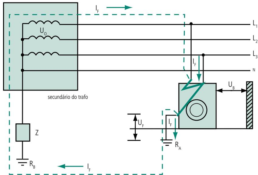
**Figura 10.3: Esquema IT – impedâncias de aterramento**
