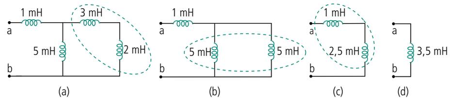
**Figura 5.9: Associação mista de indutores: (a) Indutores em série na associação mista; (b) Indutores em paralelo na associação mista; (c) Indutores equivalentes em série; (d) Indutância equivalente total do circuito**
