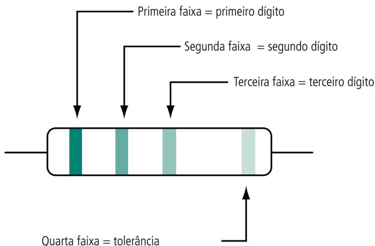
**Figura 4.6: Resistor e seu código de cores**
