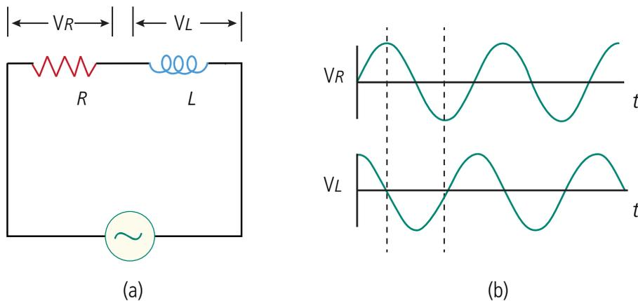
**Figura 9.11: Tensões em um circuito RL em CA**
