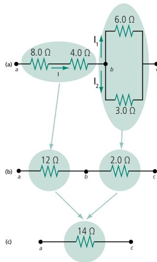
**Figura 5.7: Associação mista de resistores: (a) Dois resistores em série conectados a dois resistores em paralelo; (b) Circuito equivalente às associações em série e paralelo; (c) Resistência equivalente total do circuito**
