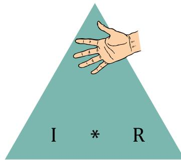
**Figura 6.2: Valor de tensão usando o triângulo VIR**
