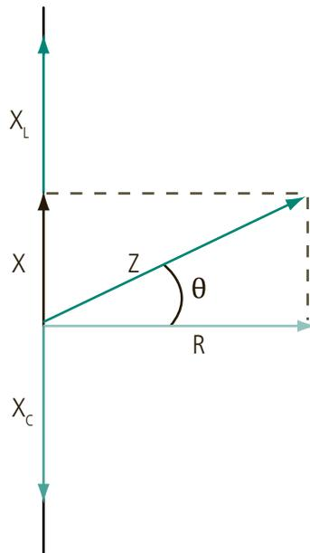
**Figura 9.3: Diagrama vetorial para a impedância de um circuito**
