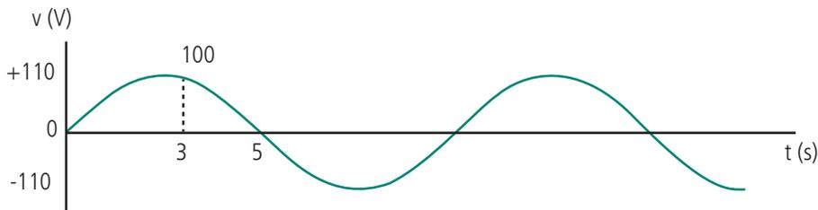
**Figura 3.6: Valor instantâneo de uma onda senoidal**
