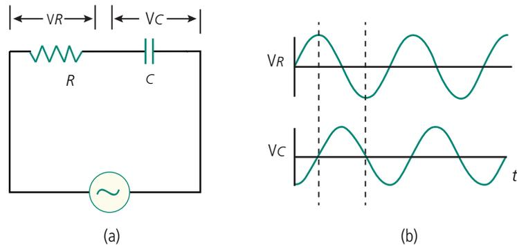
**Figura 9.9: Tensões em um circuito RC em CA**
