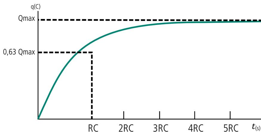
**Figura 9.8: Evolução temporal da carga no capacitor (carga)**
