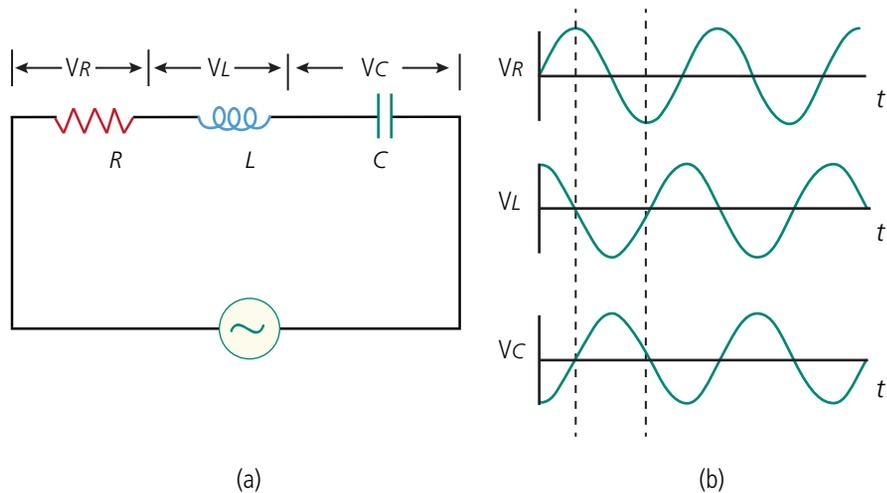
**Figura 9.12: Tensões em um circuito RLC em CA**
