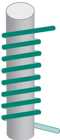
**Figura 4.10: Fio enrolado em torno de um núcleo**
