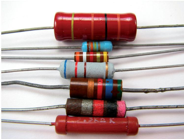
**Figura 4.4: Resistores fixos**
