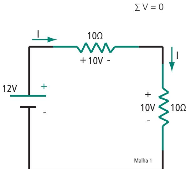
**Figura 7.3: Tensões ao longo de um percurso fechado**
