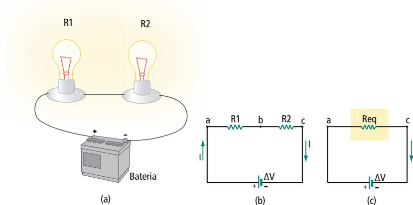
**Figura 5.1: Associação em série de resistores: (a) Duas lâmpadas em série conectadas a uma bateria; (b) Representação gráfica do circuito das lâmpadas em série; (c) Circuito equivalente das lâmpadas em série**
