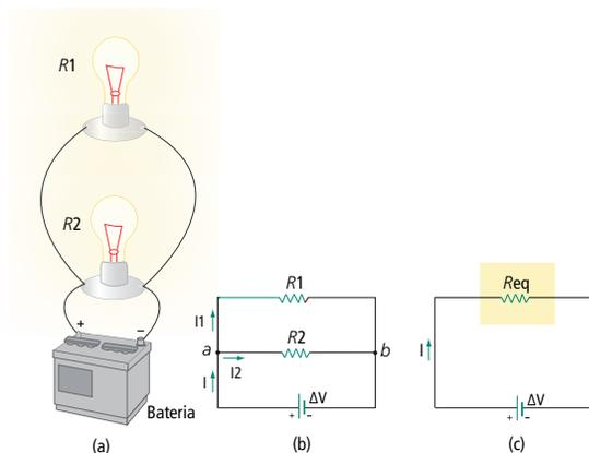
**Figura 5.4: Associação em paralelo de resistores: (a) Conexão em paralelo dos resistores R1 e R2, a diferença de potencial do resistor R1 é igual a do resistor R2; (b) Representação gráfica do circuito dos resistores em paralelo; (c) Circuito equivalente dos resistores em paralelo**
