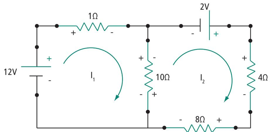
**Figura 7.4: Equações das malhas de um circuito**
