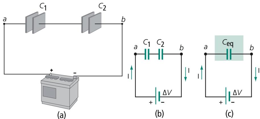
**Figura 5.2: Associação em série de capacitores: (a) Dois capacitores em série conectados a uma bateria; (b) Representação gráfica do circuito dos capacitores em série; (c) Circuito equivalente dos capacitores em série**
