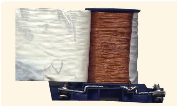
**Figura 10.4: Detalhe interno da bobina – espiras**
