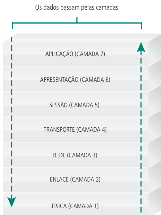
Figura 2.2: As sete camadas do modelo OSI
