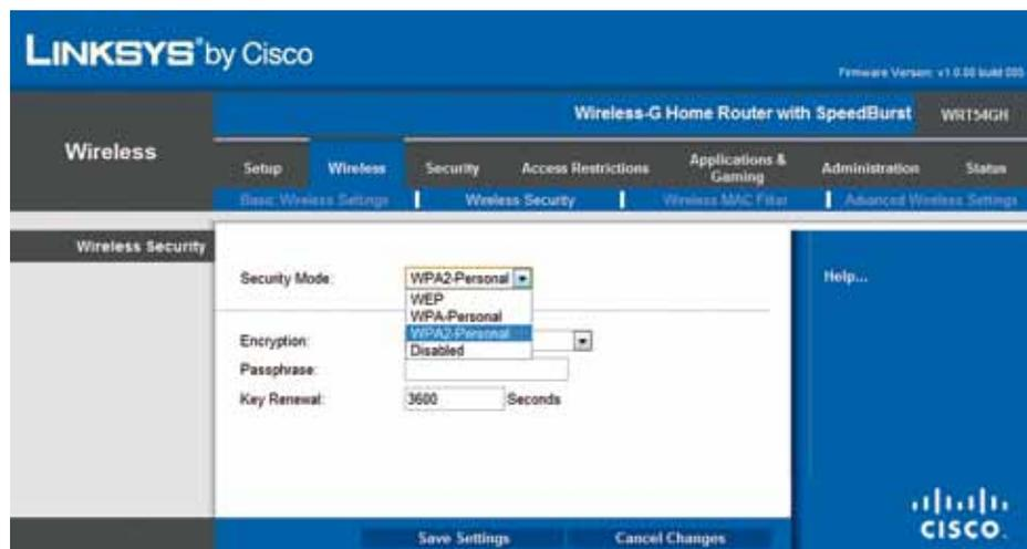
**Figura 6.9:** Roteador sendo configurado com a chave de criptografia WPA2
