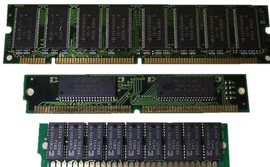
**Figura 4.4: Módulos DIMM**
