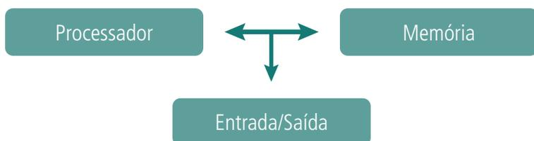
**Figura. 1.1:** Elementos de *hardware*.
